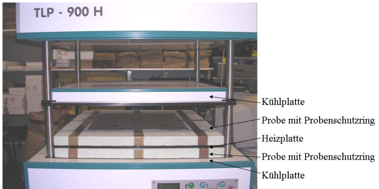
▪ Bild 10: Eingebaute obere Probe mit aufgelegter Thermoelementfolie
